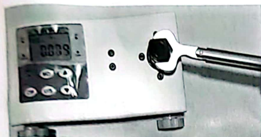
射频头扭力扳手通过扭力测试仪调节扭力值
