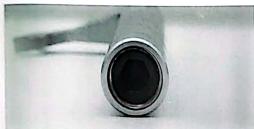
当扭力不符时，使用内六角扳手在扭力扳手尾部进行扭力调整，顺时针调大，逆时针调小
